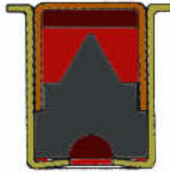
Fig. 20 – Diagrama de espoleta Bateria.
