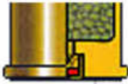
Fogo Central: A mistura detonante está disposta em uma espoleta, fixada no centro da base do estojo.
